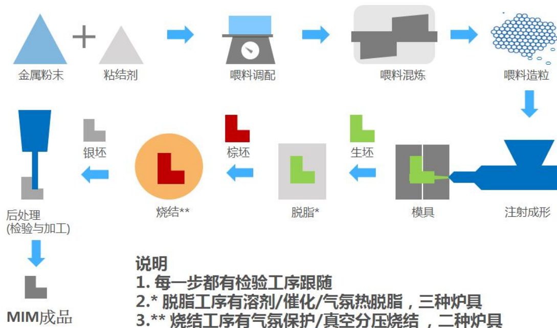
图1 钨合金注射成型质量块生产工艺流程图
